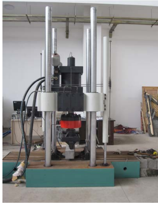
结构实验室疲劳试验机
